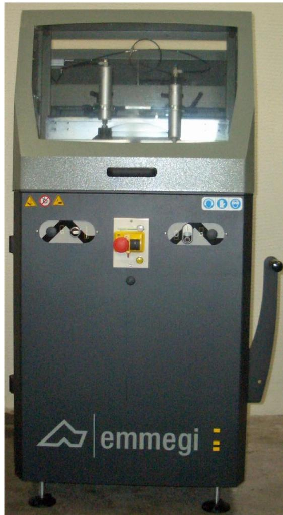
Permettant des coupes droites et biaisées jusqu'à +/- 75°.
