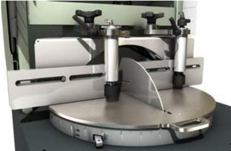
*Etaux pneumatiques verticaux*
